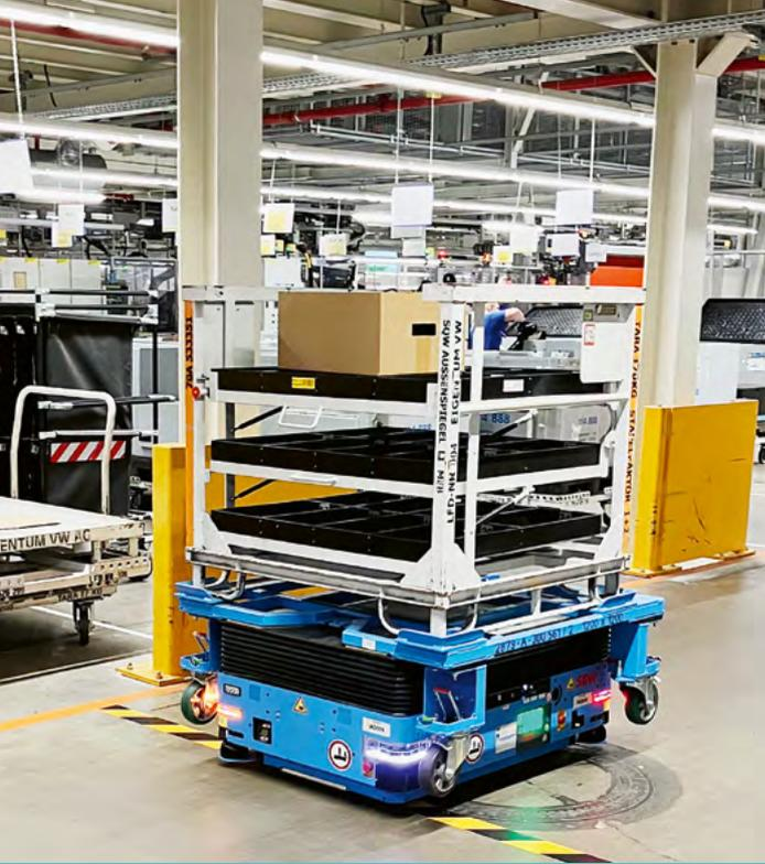
Die autonomen Transportplattformen (links) sind mit Kameras und Sensoren ausgestattet, die Hindernisse erkennen und dem Fahrzeug signalisieren, wann es stoppen muss.
